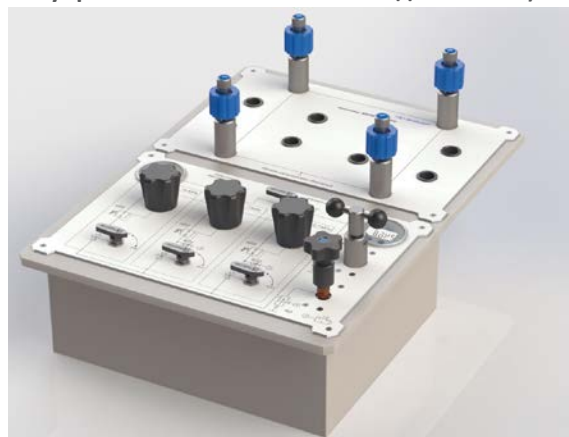
Панель регулировки давления, совмещенная с коллектором для одновременной поверки до 4-х СИ давления (механизированное управление пневматическим давлением)
